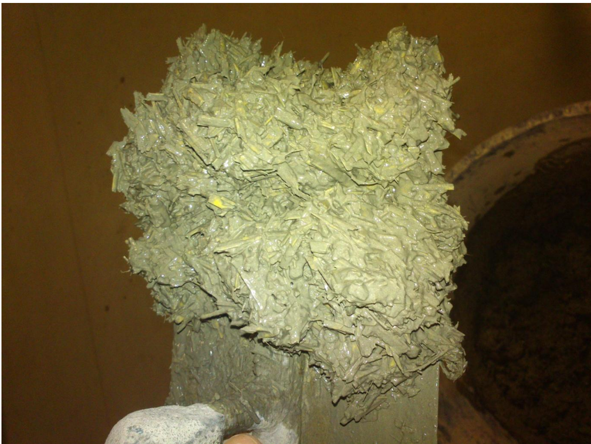
Obr. 22 Konopný beton (KB 800) v čerstvém stavu
