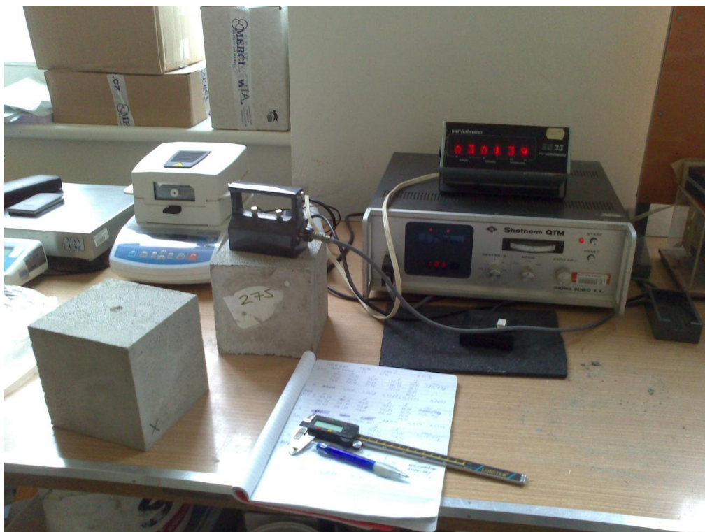
Obr. 23 Přístroj Shotherm QTM při práci
