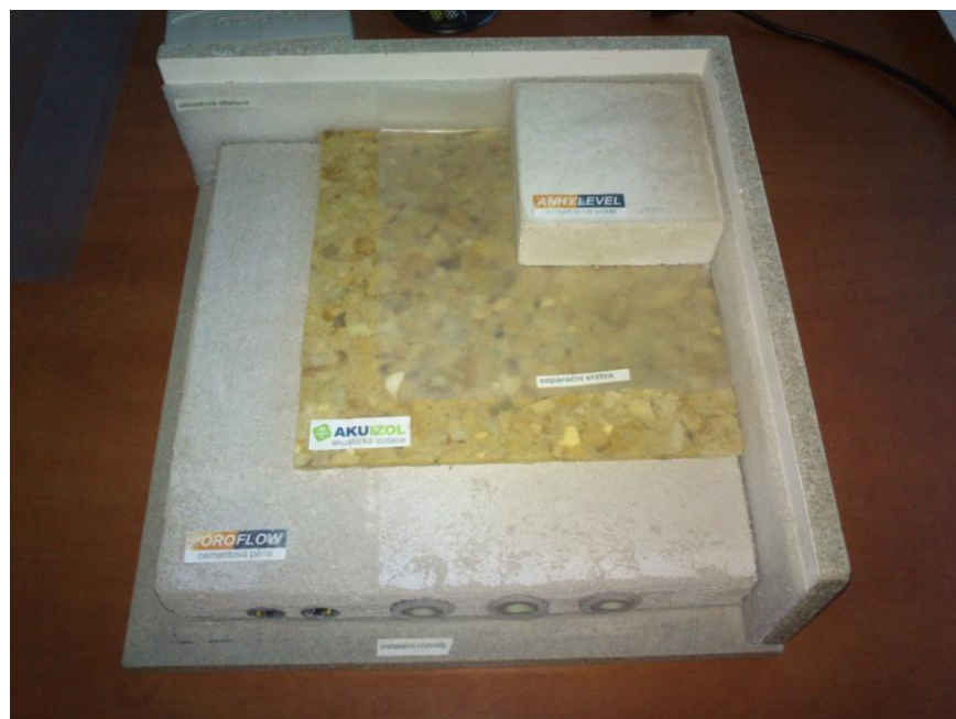
Obr. 29 Model Varianty 4 - kombinace pěnobetonu a Akuizolu
