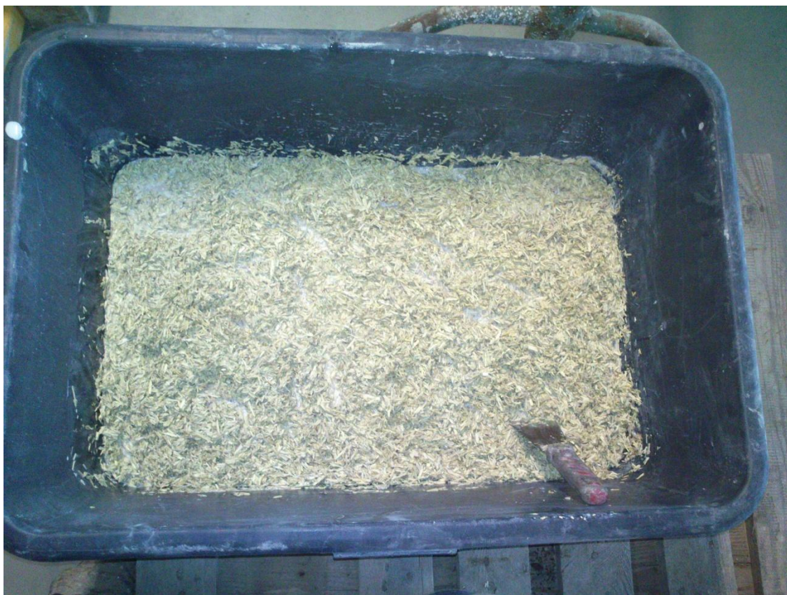
Obr. 21 Konopné pazdeří během mineralizace
