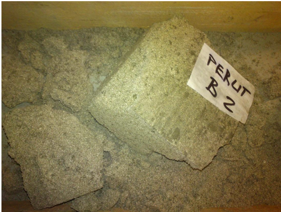
Obr. 20 Zkušební tělesa receptury PTB 600 se během odformování rozpadla
