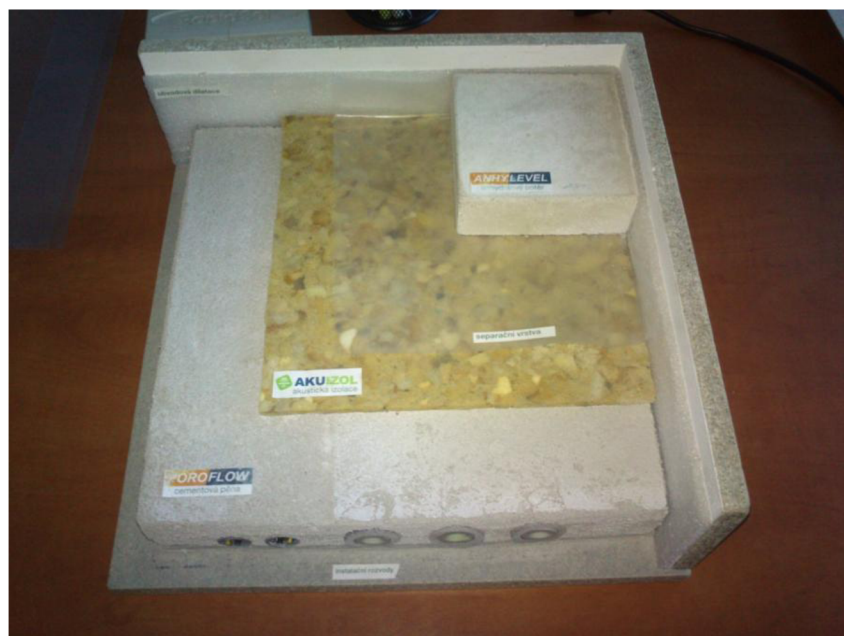
Obr. 29 Model Varianty 4 - kombinace pěnobetonu a Akuizolu
