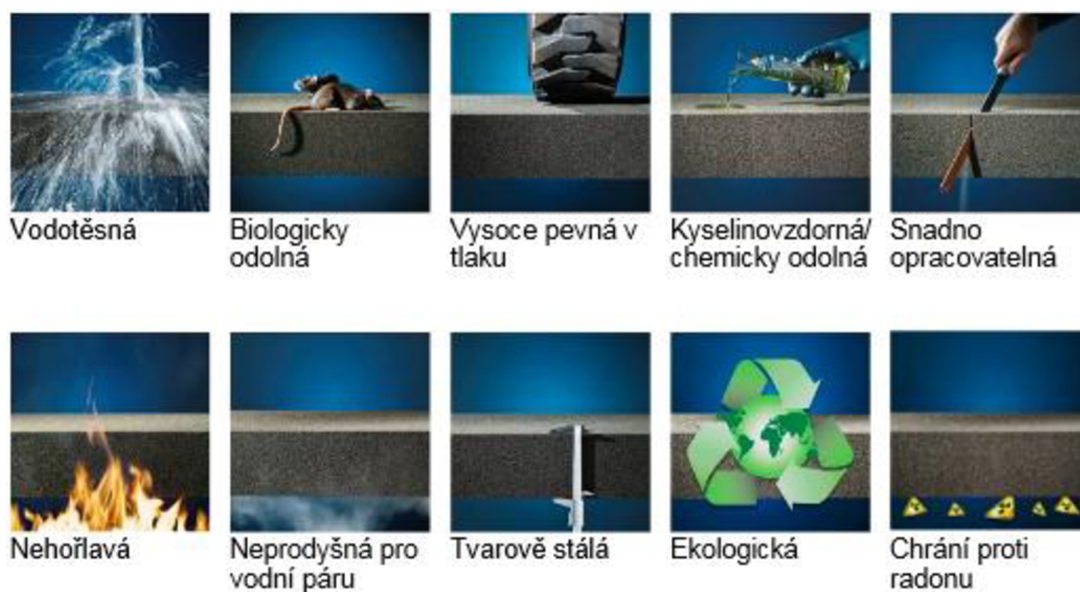
Obr. 15 Soubor fyzikálně - mechanické vlastností pěnového skla
