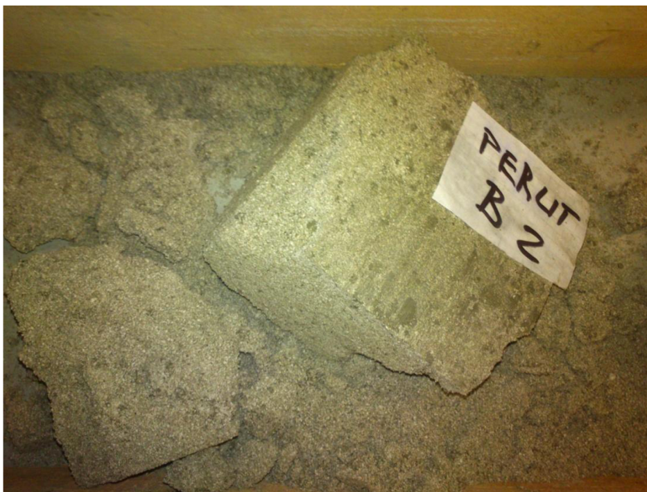
Obr. 20 Zkušební tělesa receptury PTB 600 se během odformování rozpadla
