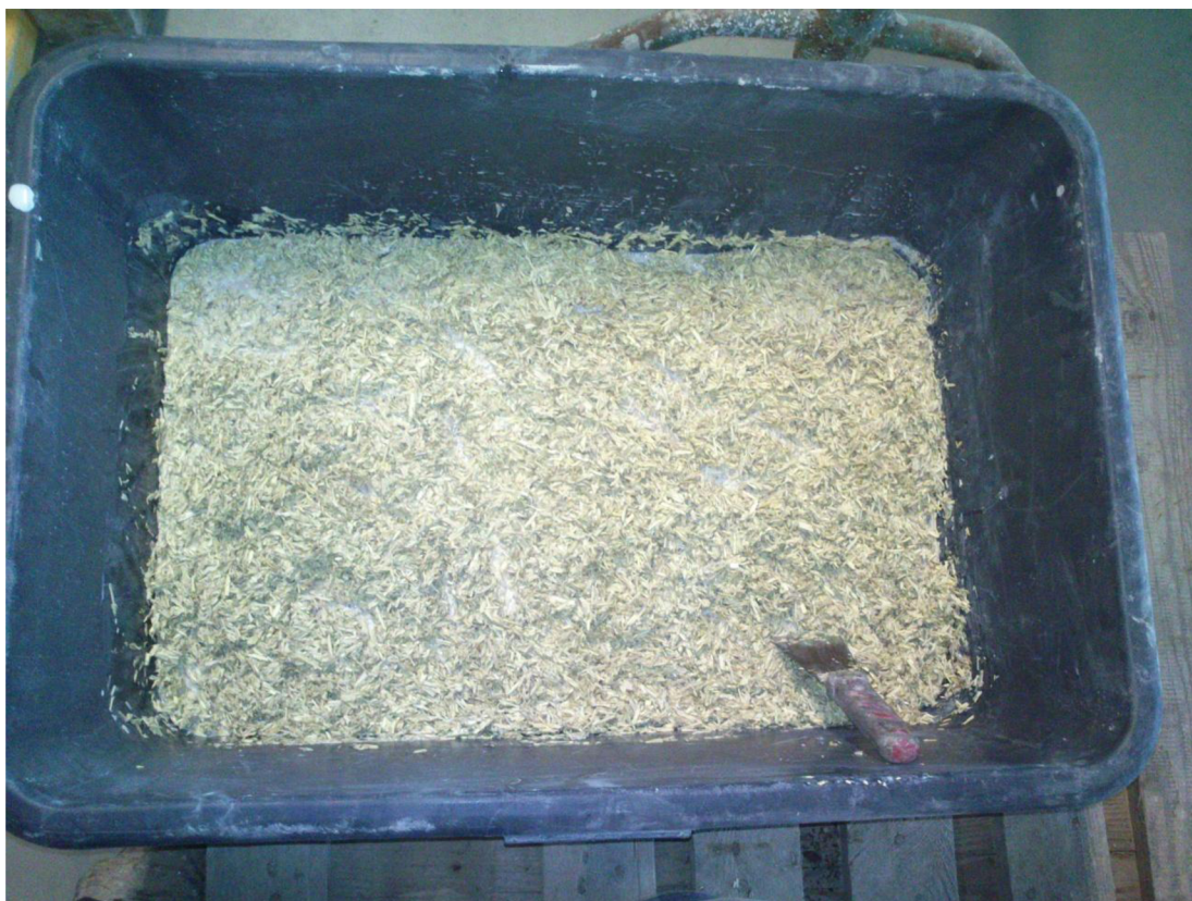
Obr. 21 Konopné pazdeří během mineralizace
