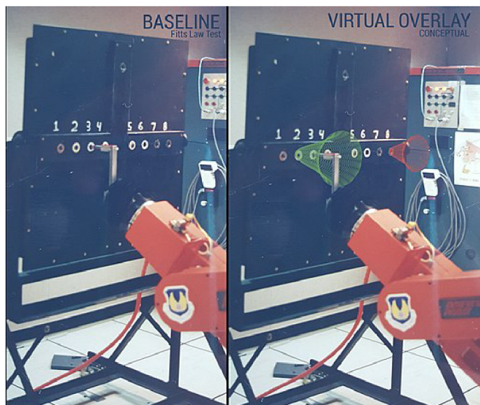
Obrázek 3.3: Ukázka Virtual fixtures použitého ke zlepšení schopnosti míření 4
