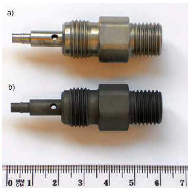
Obrázek 12 – Šroubový ventil (a) odmořený, (b) fosfátovaný dodavatelem
