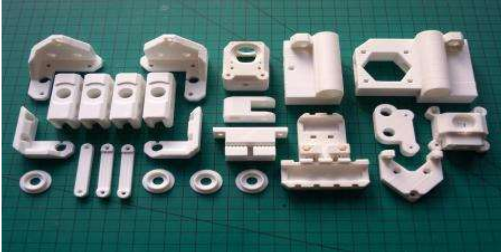
Obr. 10: Vytisknuté 3D díly na novou RepRap tiskárnu. [9]
