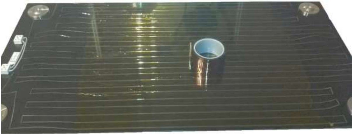
Obr. 30: Vyhřívání podložka realizovaná spirálou z měděného drátu. [32]
