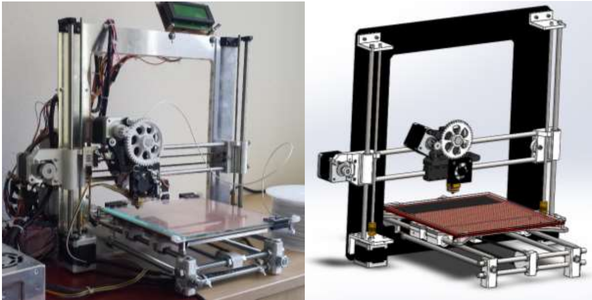
Obr. 61: Fyzický model 3D tiskárny RepRap a model vytvořený v SolidWorks.
