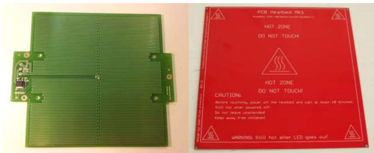
Obr. 35: Vyhříváná deska realizovaná plošnými spoji. [34]
