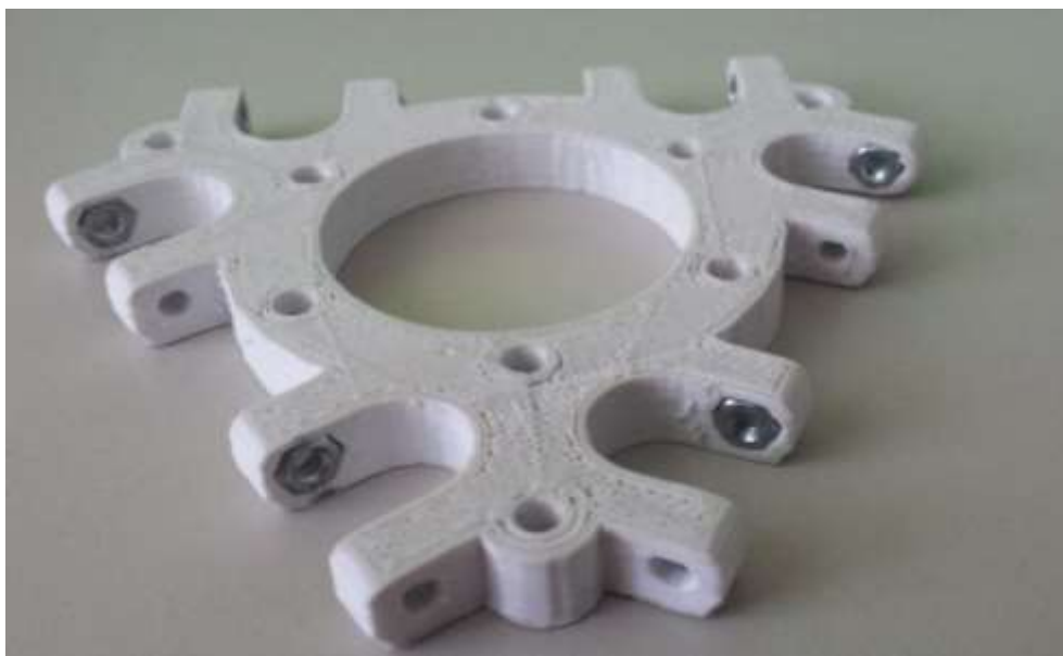
Obr. 45. Příklad vytisknutého modelu doplněného matkami.
