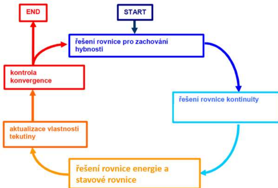
Obr. 24: Algoritmus iteračního postupu ve Flow Simulation. [29]
