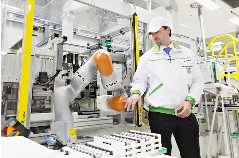
Obr. č. 7 – Kooperující robot KUKA při operaci zakládání pístů do mechatroniky (Zdroj: ŠKODA AUTO, 2018)
