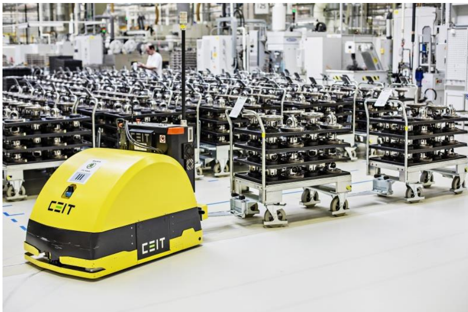
Obr. č. 3 – Bezpilotní transportní vozík CEIT v závodě Škoda Auto ve Vrchlabí (Zdroj: ŠKODA AUTO, 2018)
