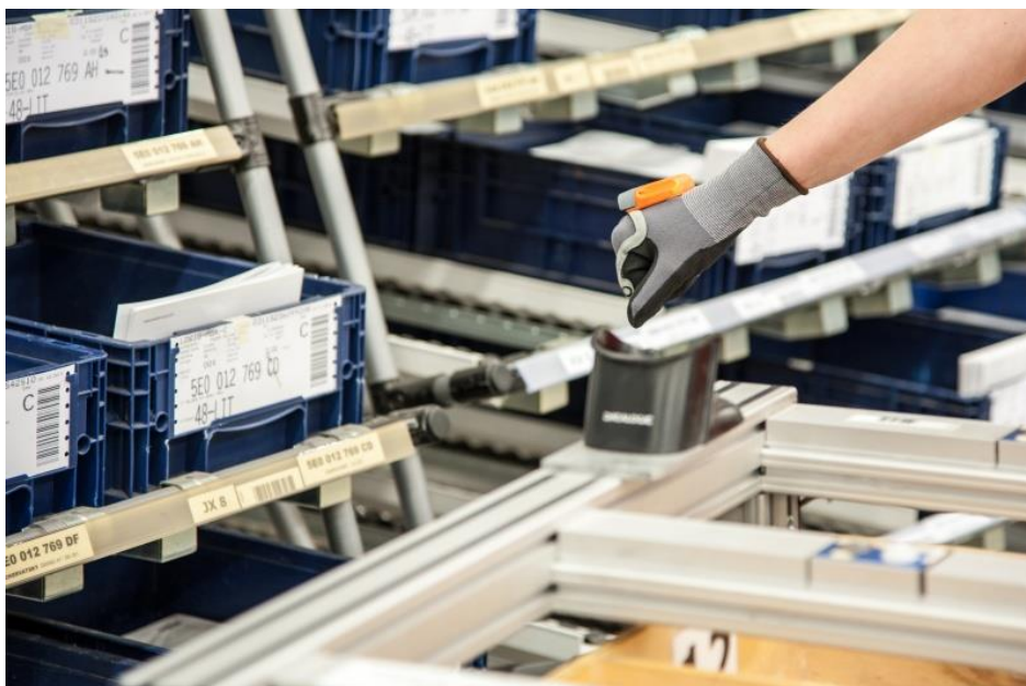
Obr. č. 4 – Chytrá rukavice ProGlove se scannerem kódů (Zdroj: ŠKODA AUTO, 2018)
