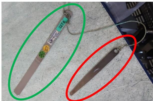
Obrázek 63: Označené a neoznačené měřidlo
