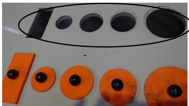
Obrázek 16: Nedostatečné zakrytí horní strany
