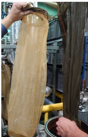
Obrázek 50: Čistý vs špinavý filtr
