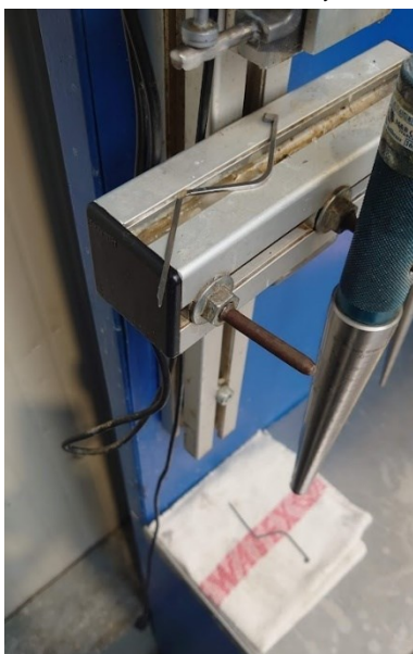
Obrázek 25: Volně visící kabely
