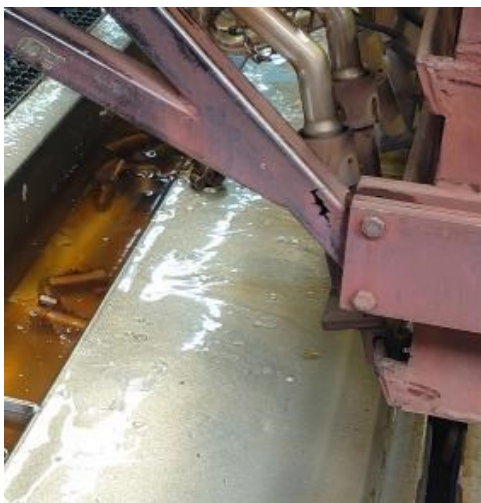
Obrázek 29: Prasklina na vozíku
