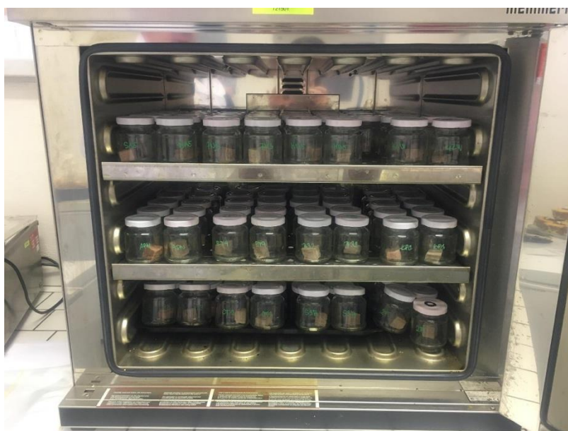
Obrázek 7: Vzorky v sušárně (Mettmert UML500)
