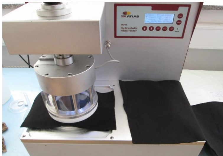
Obr. 27 Vzorek č. 1 – měření na přístroji Hydrostatic Head tester
