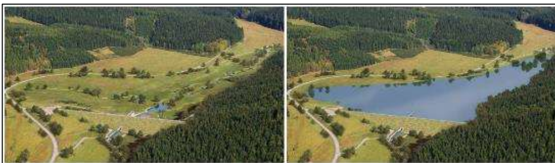
Obrázek 3: Vizualizace suché nádrže při běžném průtoku (vlevo) a při naplnění (Aquatris, nedat.), úprava autor.
