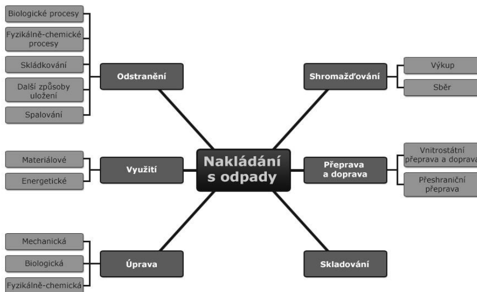
Obrázek 1 Schéma nakládání s odpady (zdroj: CENIA, www.vitejtenazemi.cz )
