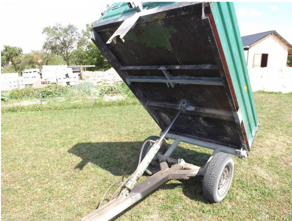
Obr. 31 Posun otočného bodu na konec korby proveden v praxi [10]
