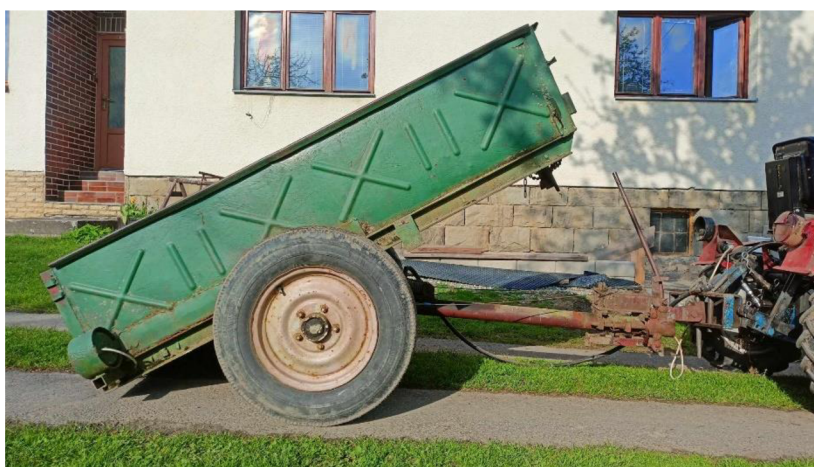
Obr. 3 Výklopnost sklápěcí nástavby na rovině
