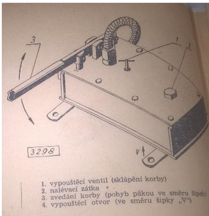
Obr. 11 Schematické zobrazení ručního hydrogenerátoru [2]
