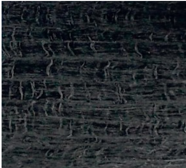
Obr. 13 Řez izolačním materiálem z uhlíkových vláken. [27]
