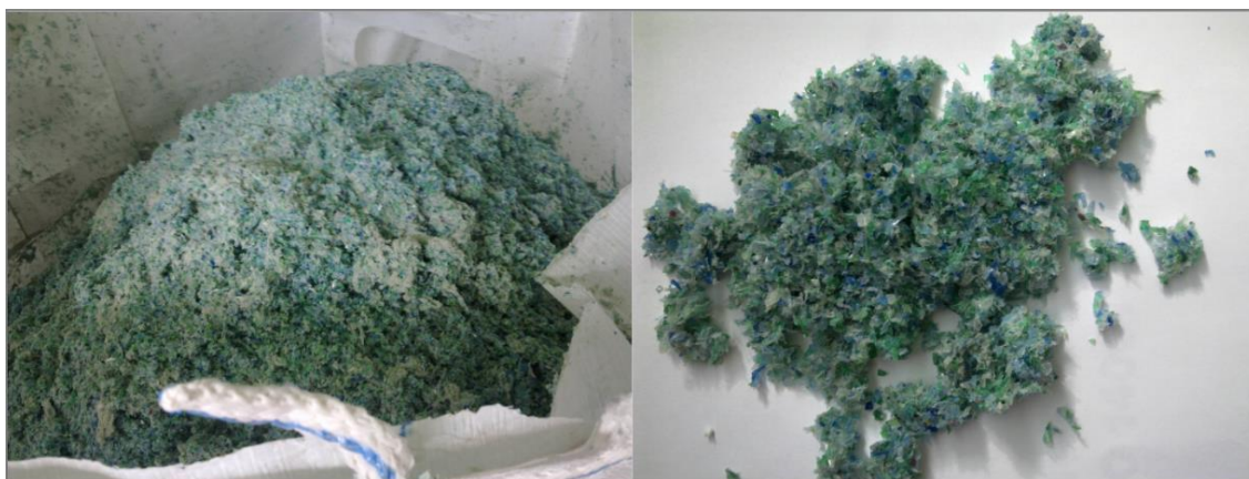
Obrázek 22: Výstup z odstředění zbytkové vody - PET drť vlhká [zdroj PETKA CZ, a.s.]
