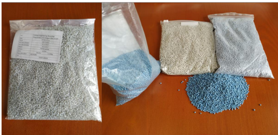
Obrázek 16: Příklady regranulátu [vlastní zdroj]
