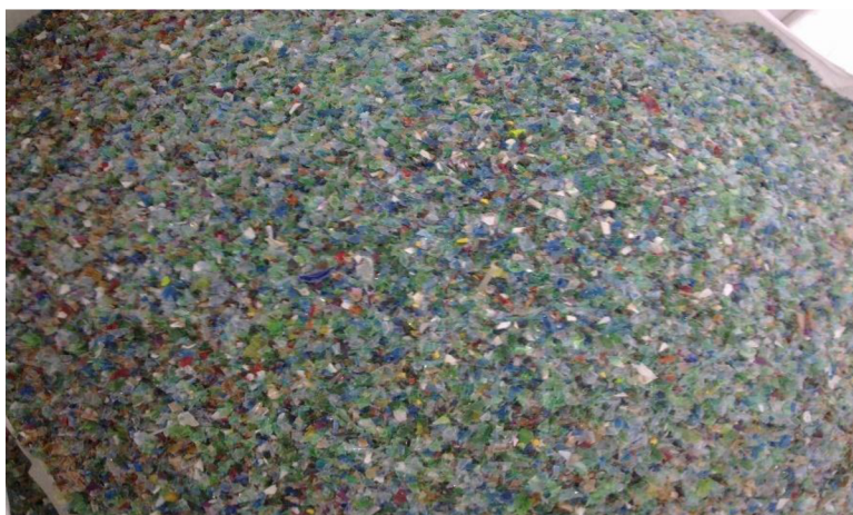
Obrázek 19: Výstup z automatického sorteru [zdroj PETKA CZ, a.s.]
