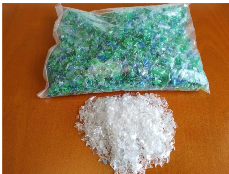
Obrázek 15: rPET flakes z výroby společnosti PETKA CZ, a. s. [vlastní zdroj]
