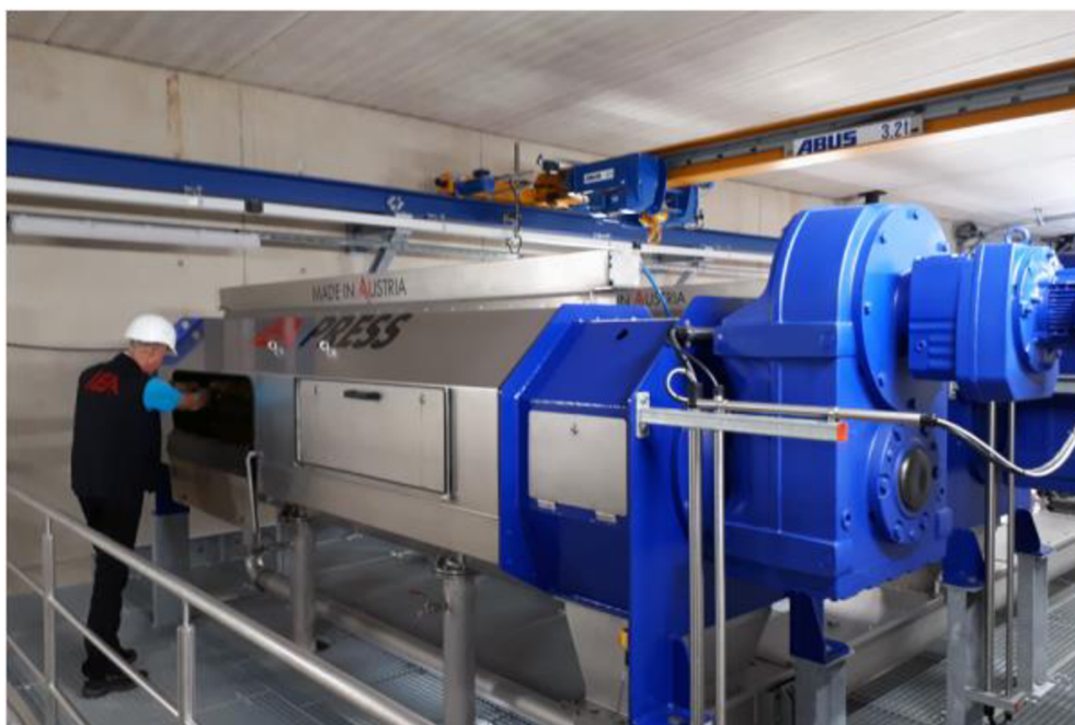
Obrázek 255: Šroubový lis redukující vlhkost [31]
