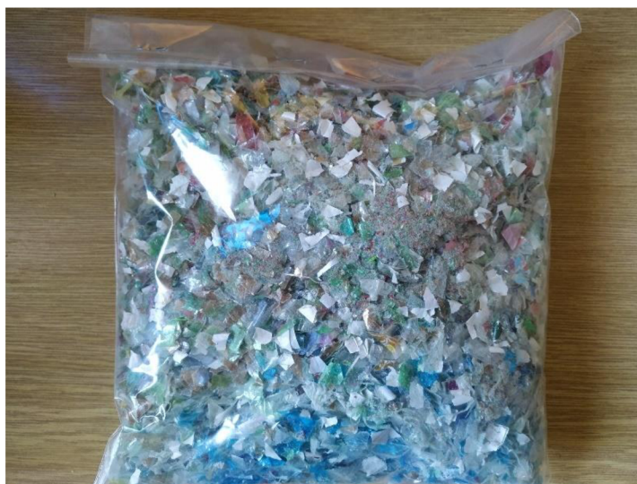
Obrázek 20: Vzorek PET prachu s podílem etiket [vlastní zdroj]
