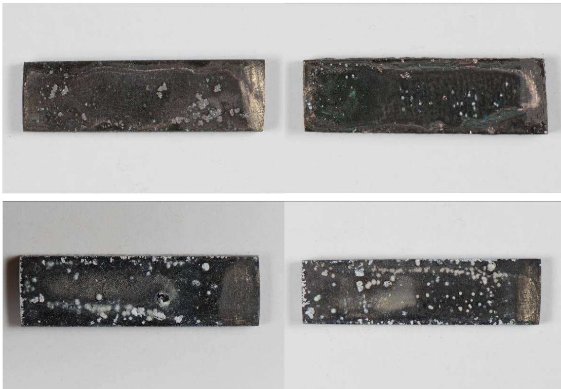
Obr.34 Ukázka vzorků po plazmochemickém ošetření při výkonu 400 W, kontinuální režim (vlevo nahoře), 25% pulzní režim (vpravo nahoře), 50% pulzní režim (vlevo dole), 75% pulzní režim (vpravo dole)
