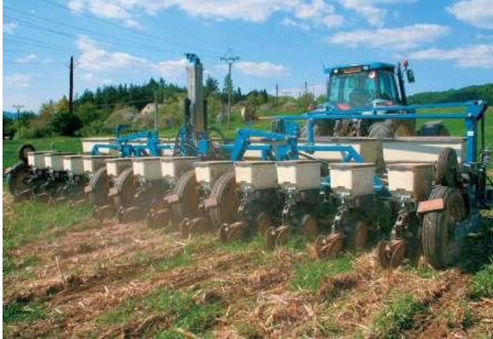
Obrázek 8 Přesný secí stroj Kinze 3600 vhodný pro zakládání porostů v bezorebných systémech (zdroj: www.pal.cz )
