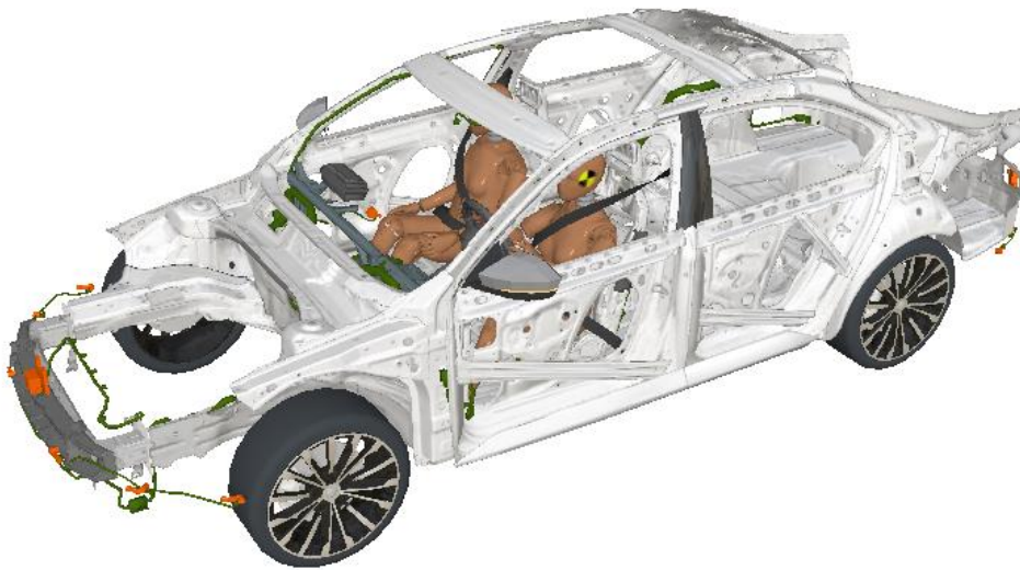
Obrázek 7: Počátek čelního nárazu [7]
