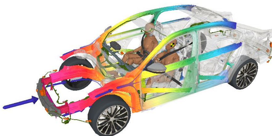
Obrázek 13: Zatížení karoserie vozidla při čelním nárazu rychlostí 50 km/h [7]
