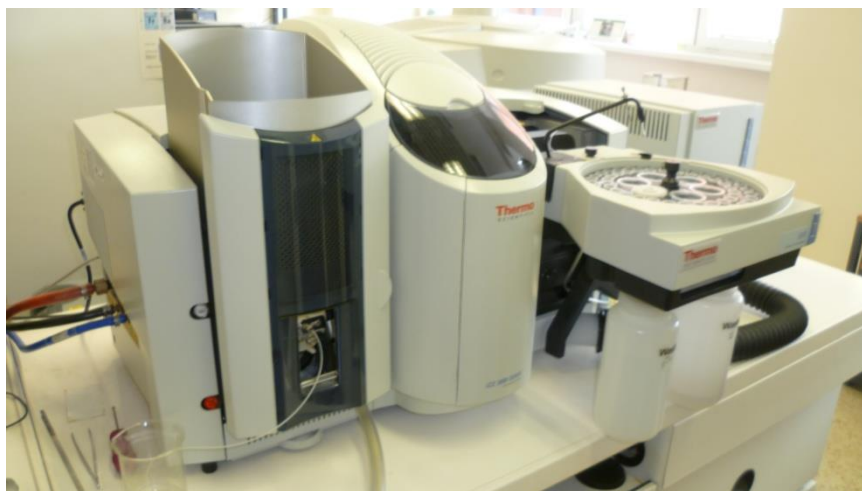
Obr. 11: AAS Thermo Scientific iCE 3500 (foto: Jiří Krejsa).
