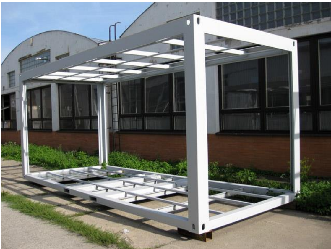
Obr. 32: Nově vyrobená ocelová rámová konstrukce
