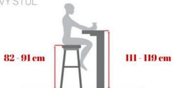
Obr. 45: Výšky sezení dle výšky barového stolu
