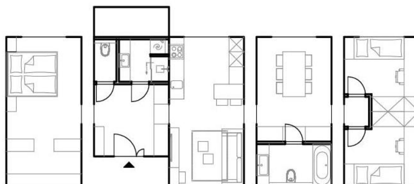
Obr. 34: Vývoj dispozičních variant modulového bydlení – varianta 1,2 (M 1:150)
