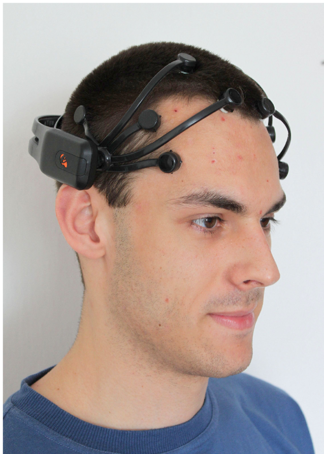
Obrázek 7.4: Snímání EEG signálu zařízením Emotiv Epoc Headset
