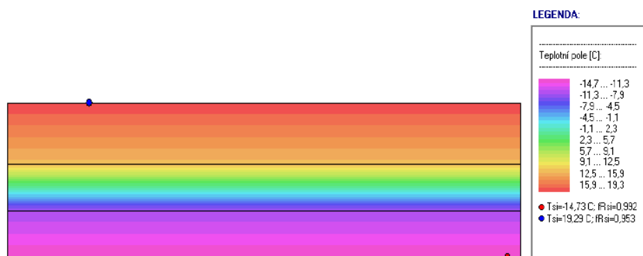
Obr. 19 Pole teplot u roubené stěny 1.NP var. 2
