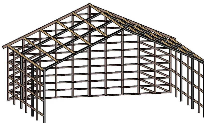
Obr. 62 Konstrukční řešení skladu na krmivo
