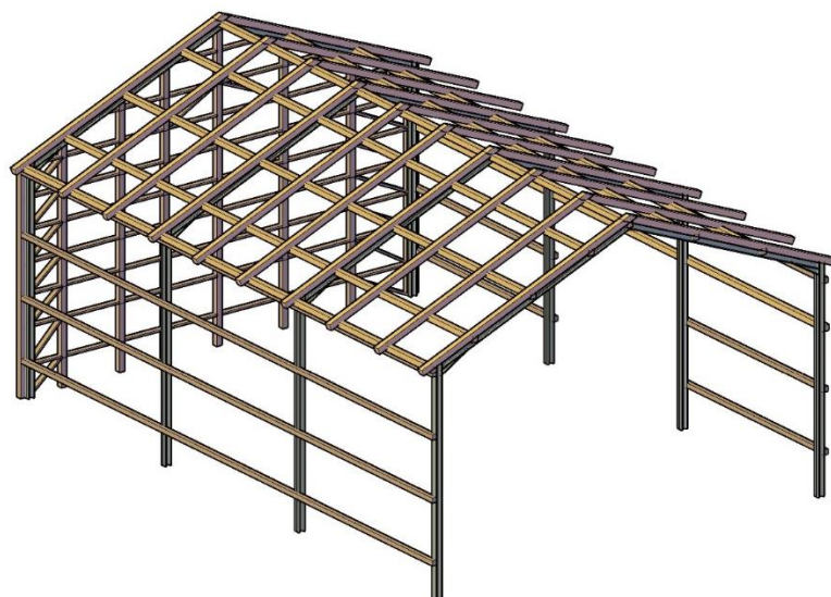
Obr. 41 Konstruktivní řešení skladu
