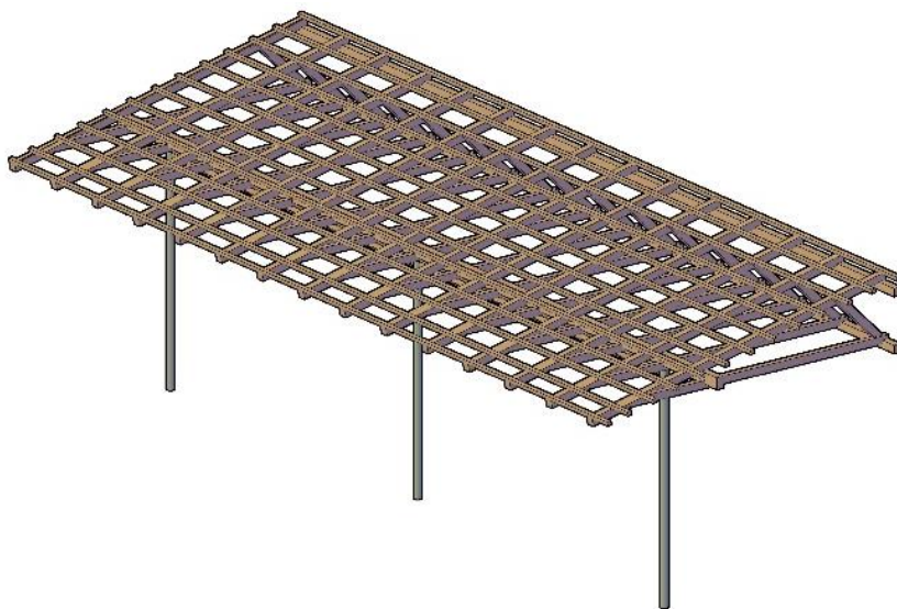
Obr. 16 Nosná konstrukce přístřešku
