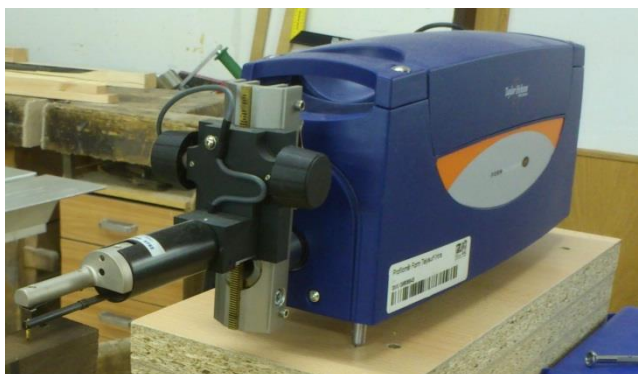
Obr. 29 Dotykový měřicí přístroj Taylor-Hobson Intra 2
