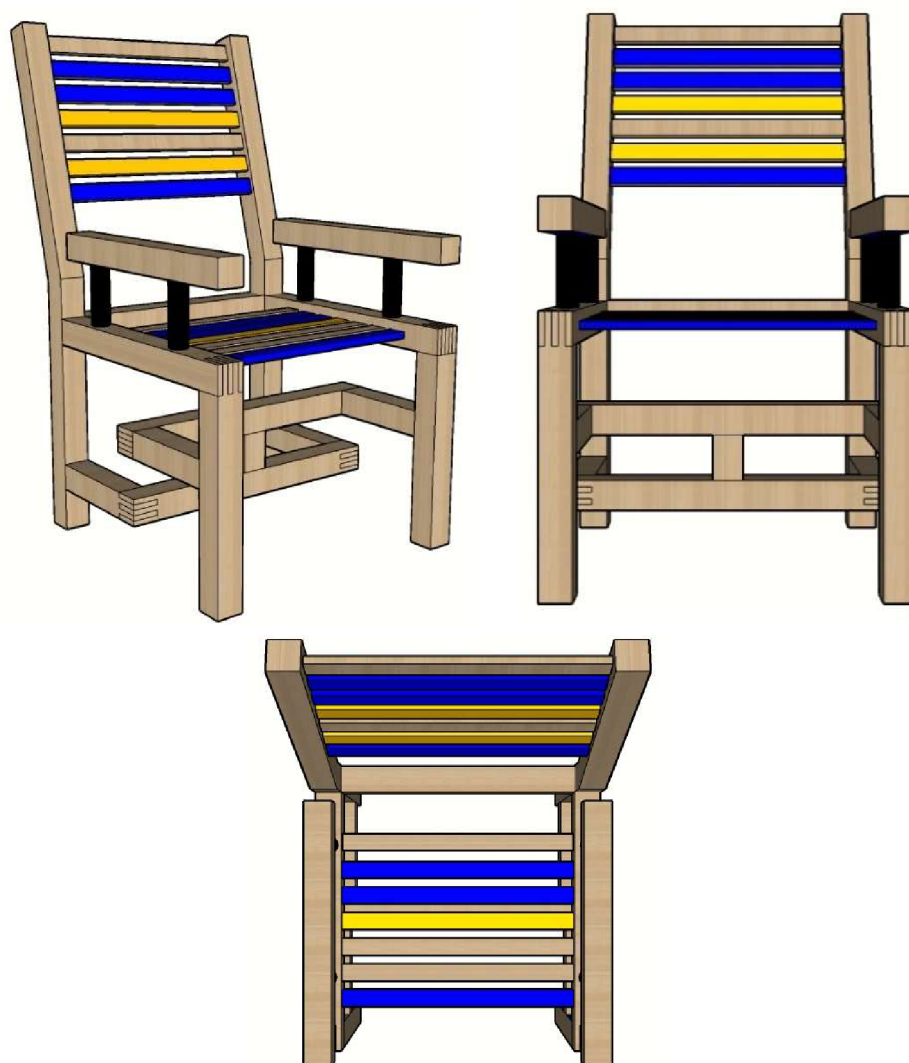
Obrázek 24. Návrh sedadla verze 6 - nárýsný, bokorysný a půdorysný pohled
