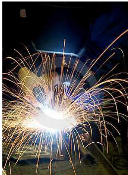
Obr. 5 Svařování v ochranné atmosféře [7].
