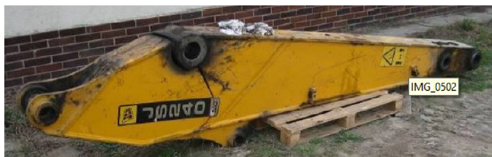
Obr. 17 Únava materiálu – vznik trhliny [9].
