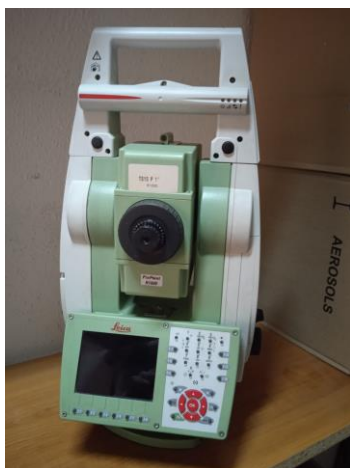
Obrázek 1.8: Totální stanice Leica TS15 (vlastní)
