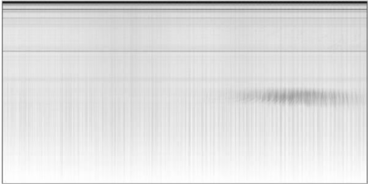
Obrázek 7.11: Získaný obraz reálného šumu snímaného na detektoru bez přítomnosti měřitelného objektu v optické dráze přístroje
