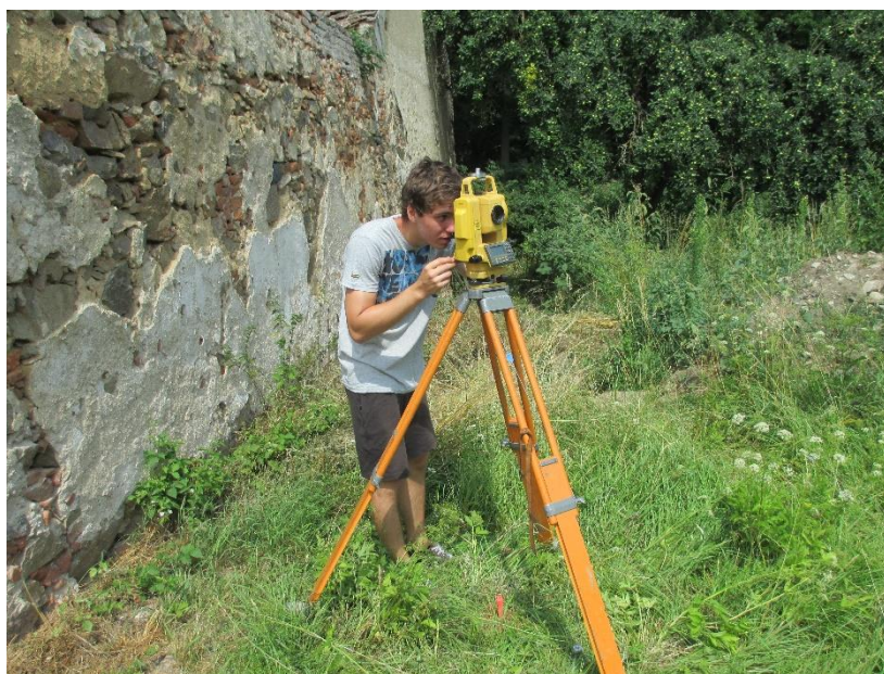
Obr. 4.2 Měření podrobných bodů
