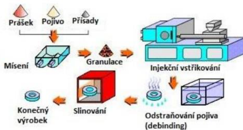
Obrázek 3.6: Jednotlivé sekvence injekčního vstřikování kovů (Skotnicová a Kurša, 2013)
