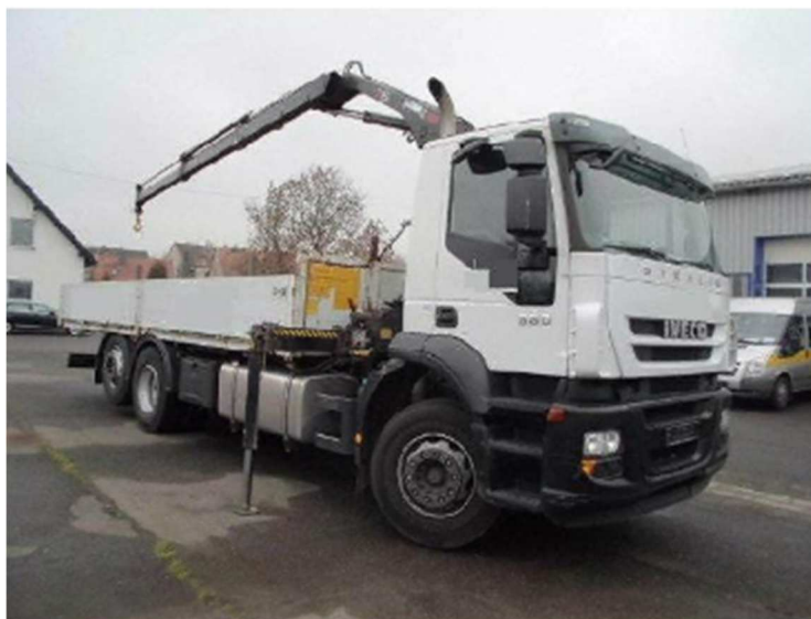
Obrázek 6-42: Nákladní automobil Iveco Stralis 360 6x2 s valníkovou nástavbou 7 m + hydraulická ruka HIAB XS 166 E-5 HiPro
