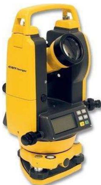
Obrázek 6-22: Teodolit CST Berger DGT 10
