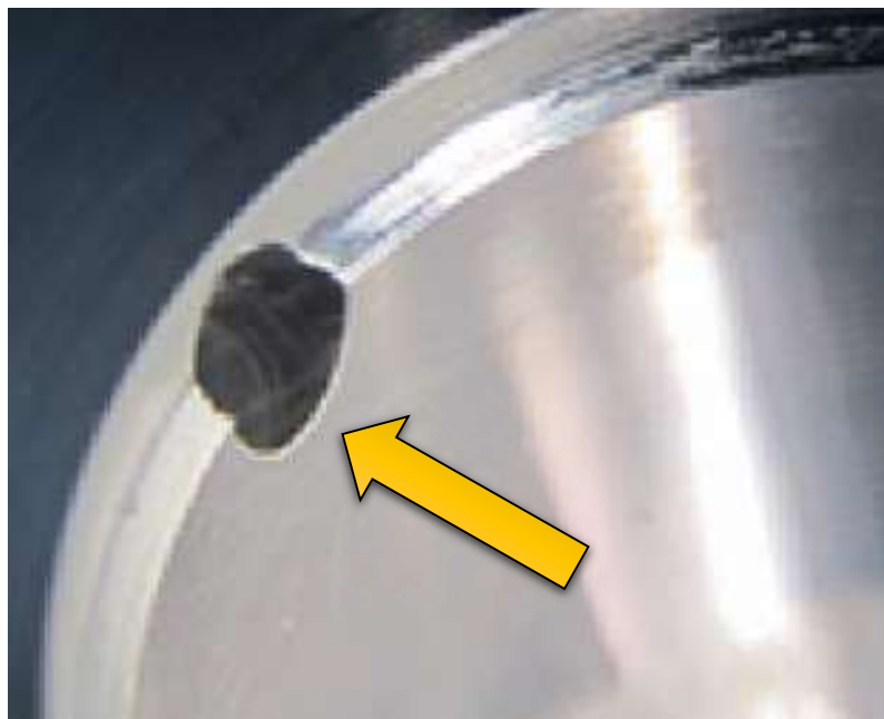
Obrázek 24: Otvor po odjehlení – v pořádku [38]
