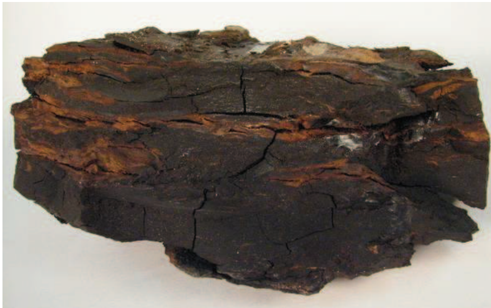
Obr. 2 Lignit - hemifázní semidetritický typ. Jihomoravský lignitový revír, důl 9. květen. Velikost vzorku 13,5×5 cm. Sbírký Geologického pavilonu VŠB-TU Ostrava, foto J. Jirásek 2006 8 .
