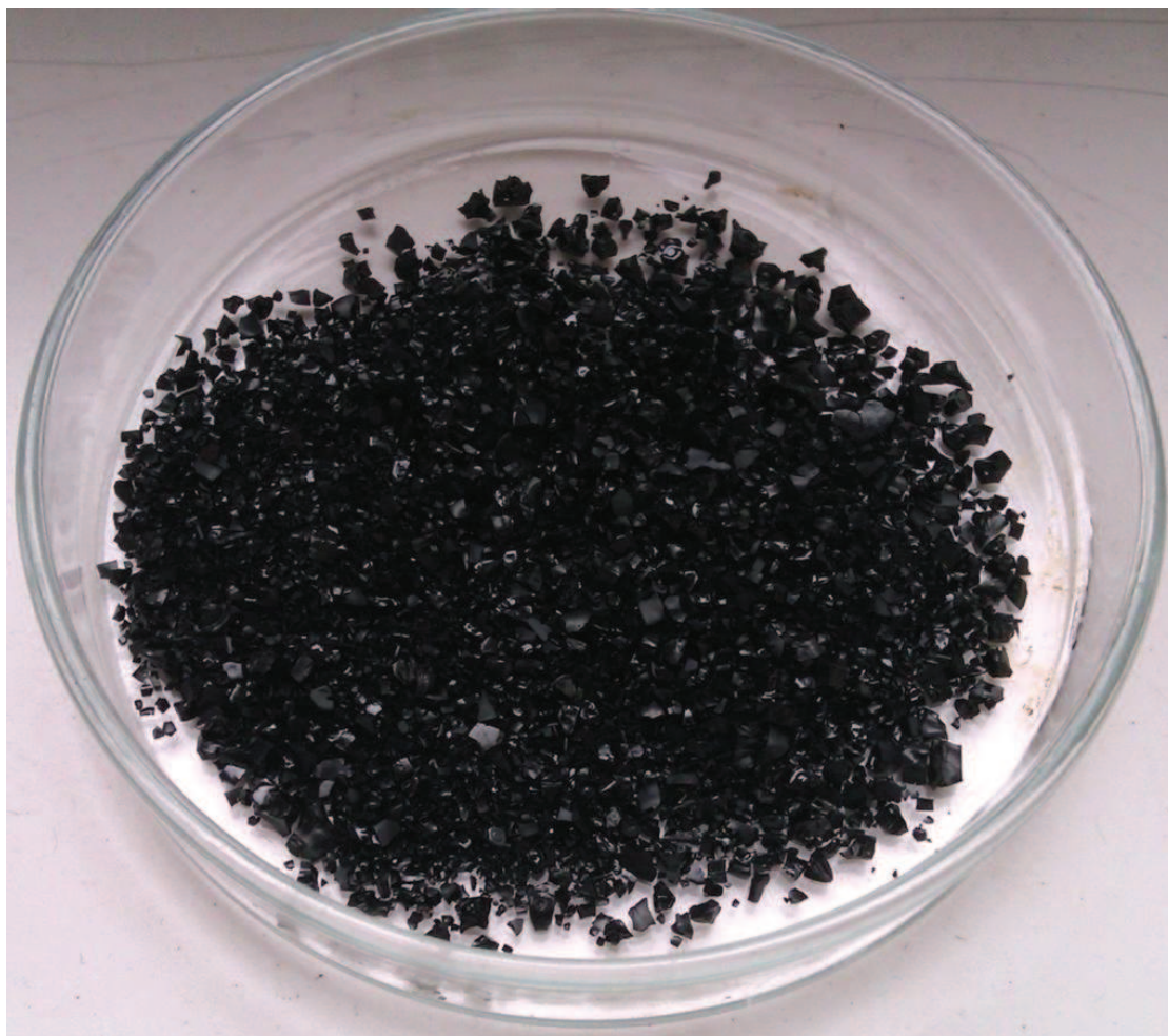
Obr. 12 Vzhled huminových kyselin izolovaných z lignitu
