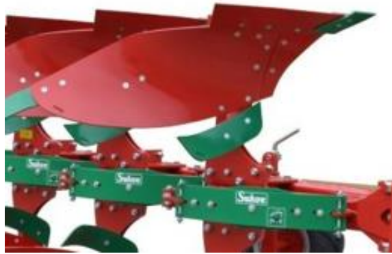
Obr. 20 Jištění orebních těles pomocí listových pružin [41]
