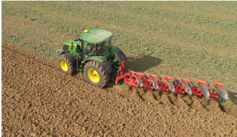
Obr. 9 Orba šestiradličným pluhem [6]
