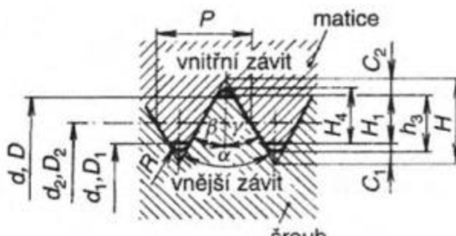
Obr. 52 Schéma jmenovitých profilů vnějšího a vnitřního metrického závitu [32]
