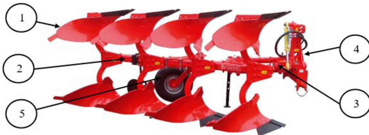
Obr. 11 Čtyřradličný pluh: 1 – orební ústrojí, 2 – rám, 3 – otočný, zdvihací a stavěcí mechanismus, 4 – tříbodový závěs, 5 – podpěrné kolo [7]
