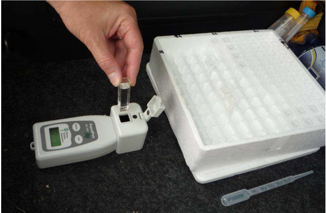
Obr. 7: Měření fluorescence pomocí AquaPen AP 100 (foto Chadtová, 2014).
