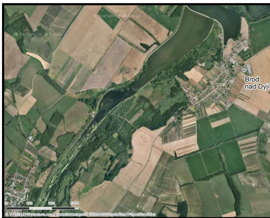
Obrázok 6.1 Ortofoto zaneseného prítoku (v ľavej časti obrázku) do hornej nádrže VD Nové Mlýny z 3. 7. 2018 (Ortofoto hornej nádrže VD Nové Mlýny, 2019)
