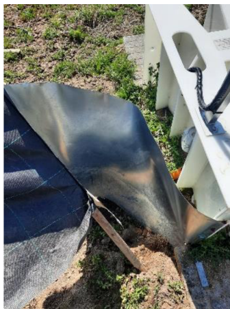
Obrázek. 10: deformace plechu spojujícího vyzarovací silt-fence a Parshallův žlab
