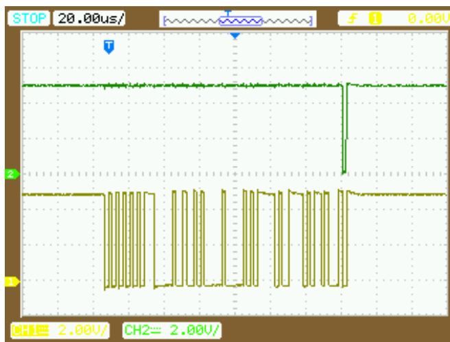
Obr. 25: Zachycení toku dat mezi MLC a CAN budičem na osciloskopu
