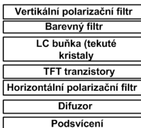
Obr. 1: LCD displej - struktura
