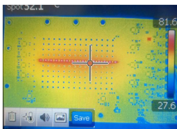
Obr. 22: Termografie - I = 1 A, aktivní 1 LED řetězec
