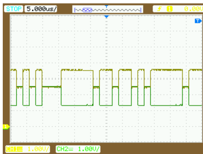
Obr. 24: Zachycení toku dat po CAN sběrnici osciloskopem
