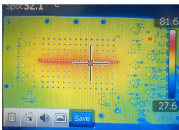
Obr. 22: Termografie - I = 1\text{A} , aktivní 1 LED řetězec
