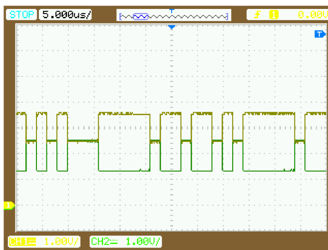
Obr. 24: Zachycení toku dat po CAN sběrnici osciloskopem
