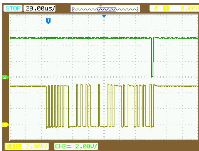
Obr. 25: Zachycení toku dat mezi MLC a CAN budičem na osciloskopu
