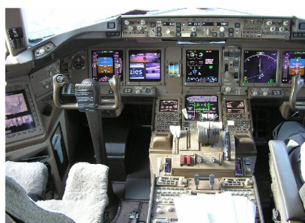
Boeing – styl řízení pomocí klasických beranů
