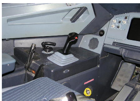
Airbus – styl řízení pomocí joysticku
