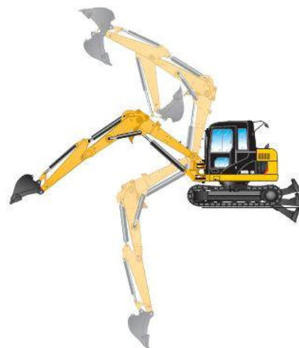
Obr. č. 43 - dosah rypadla
