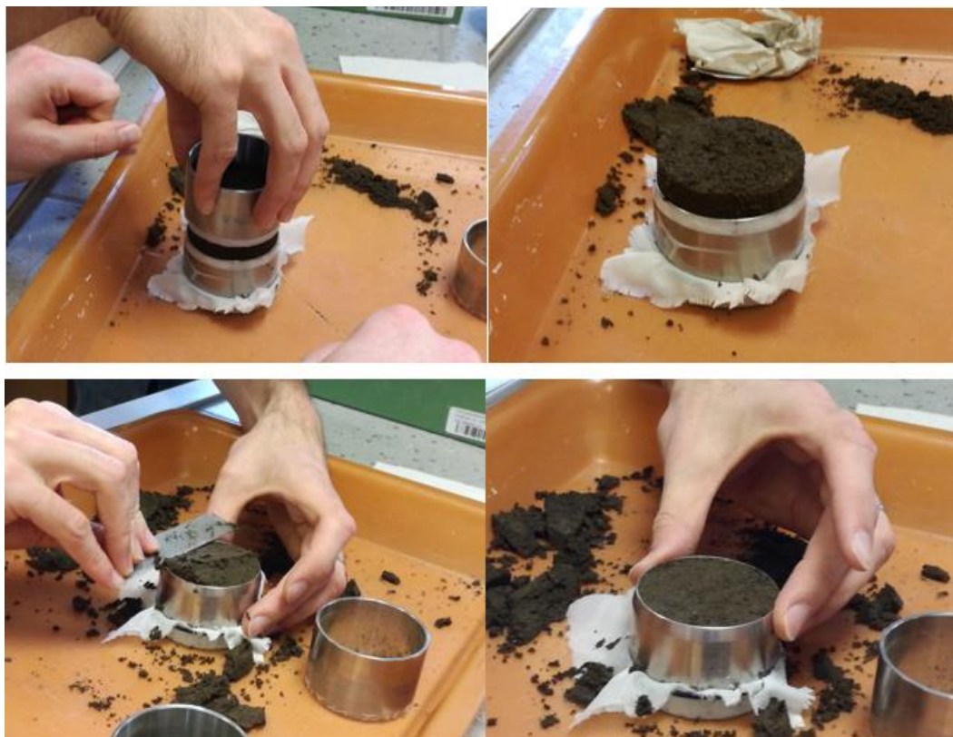
Obr. 13. Postup odřezávání Kopeckého válečku
