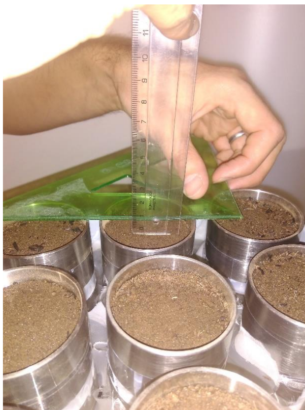
Obr. 12. Měření výšky bobtnání vzorků - nenasycený vzorek
