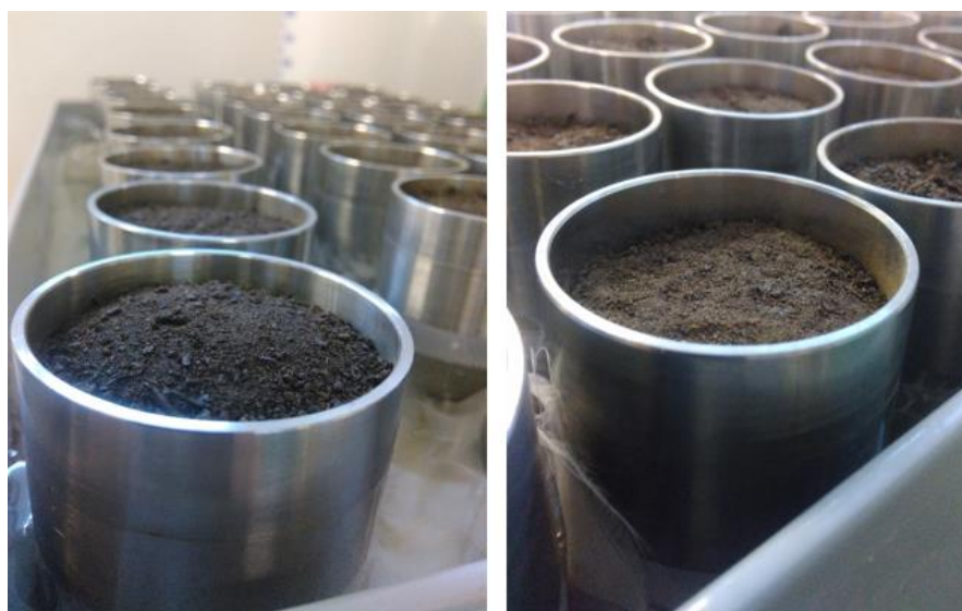
Obr. 19. Porovnání výrazného bobtnání vzorku 1BC_05 a kontrolního vzorku bez znatelného bobtnání před konsolidací
