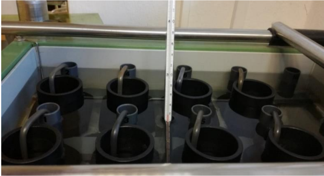
Obr. 17. Umístění vzorků s násoskami v permeamtru, dále můžeme na obrázku vidět měření teploty vody pomocí rtuťového teploměru
