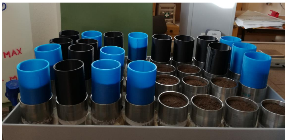
Obr. 11. Konsolidace vybraných vzorků závažím o hmotnosti 600g
