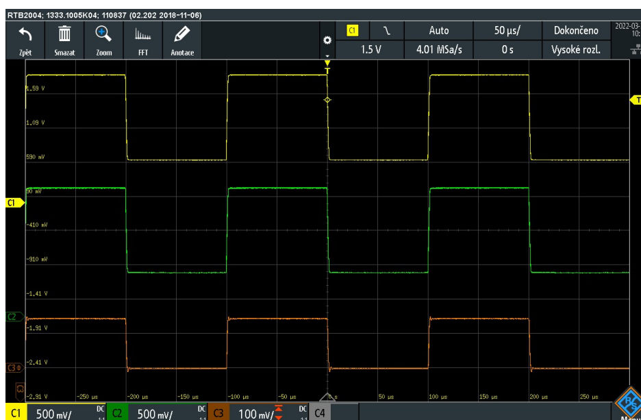
Obrázek 2.46: Měření stability dvoustupňového proudového regulátoru na vyrobeném prototypu.
