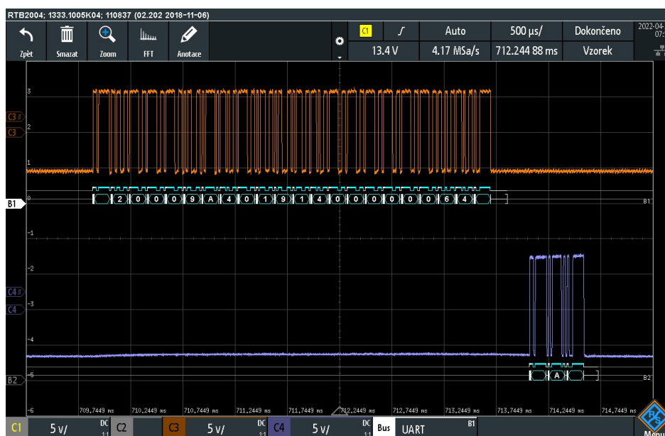
Obrázek 2.67: Ukázka komunikace počítače s testovacím zařízením přes sběrnici RS-232 – detail zprávy s požadavkem a daty s odpovědí.
