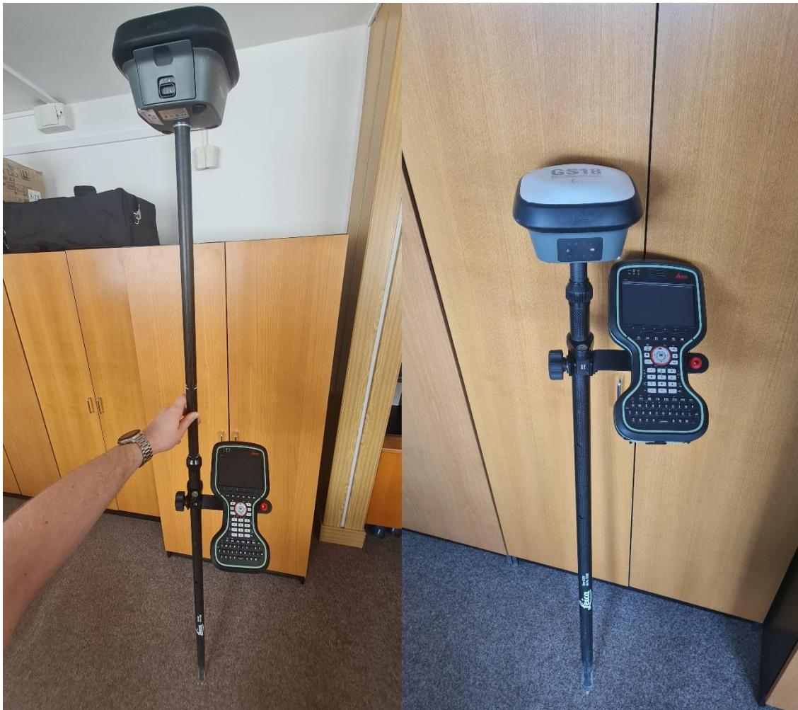
Příloha 14 GNSS přístroj Leica GS18 v rozloženém i složeném stavu Zdroj: Němec 2023
