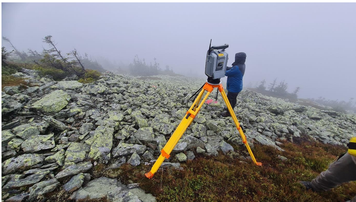
Příloha 7 Zaměřování balvanů totální stanicí na Břidličné hoře Zdroj: Němec 2022
