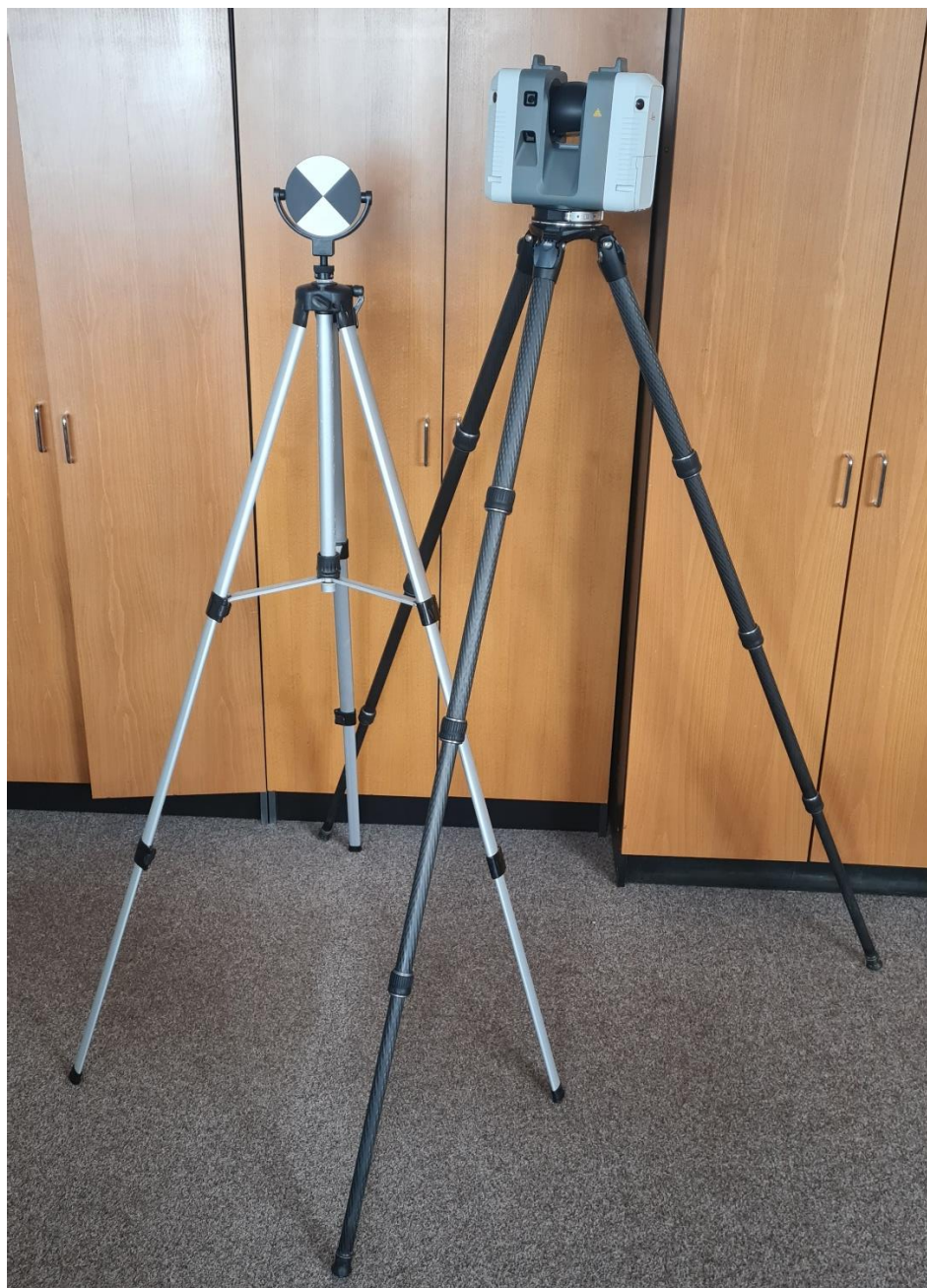
Obr. 21 Odrazový terč na stativu (vlevo) a laserový scanner Leica RTS360 3D na stativu (vpravo) Zdroj: Němec 2023
