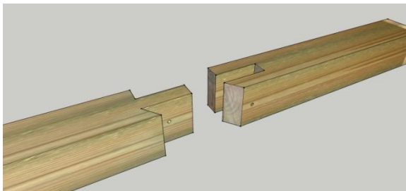
Obr. 35: Ostřihový čep na jedné straně šikmo seříznutý 3D
