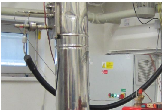
Obr. 14 Umístění sondy a hadice u kotle Dakon
