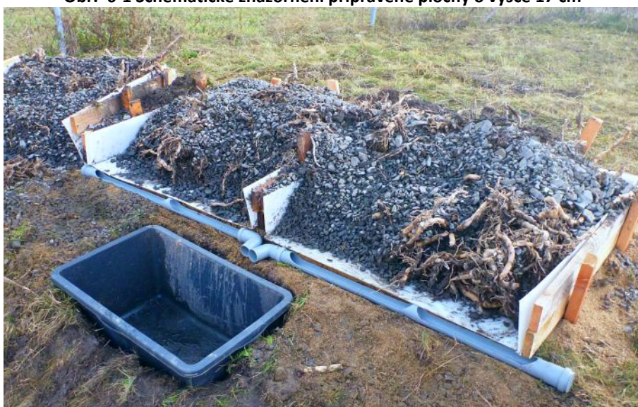
Obr. 6-2 Pohled na plochy po aplikaci zakolmatovaného filtračního materiálu
