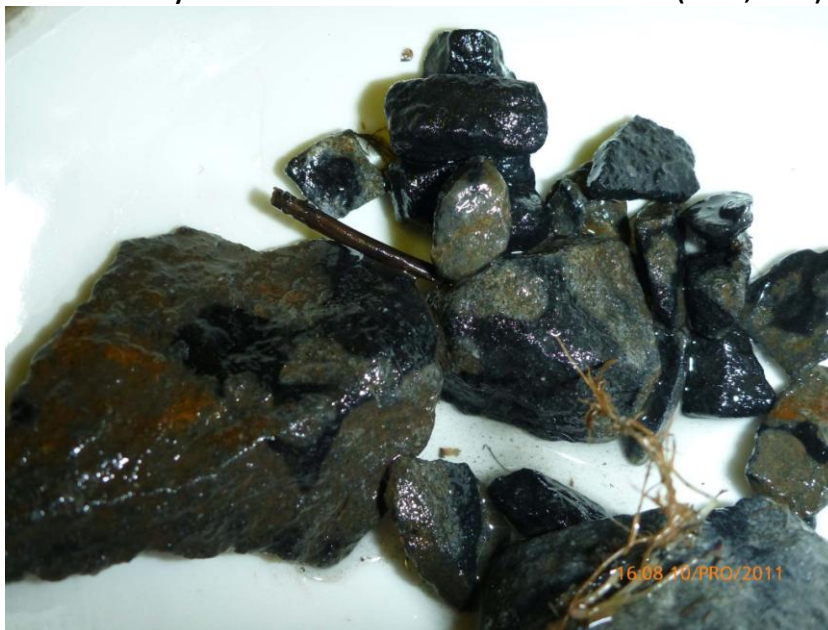
Obr. 4-2 Promývání zakolmatovaného filtračního materiálu (síta 1,0 mm)
