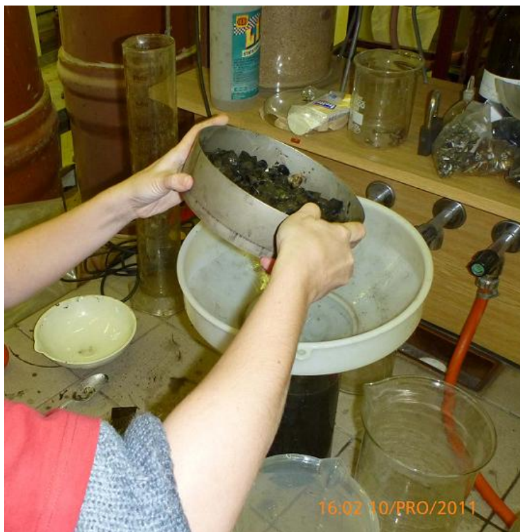
Obr. 4-2 Promývání zakolmatovaného filtračního materiálu (síta 1,0 mm)
