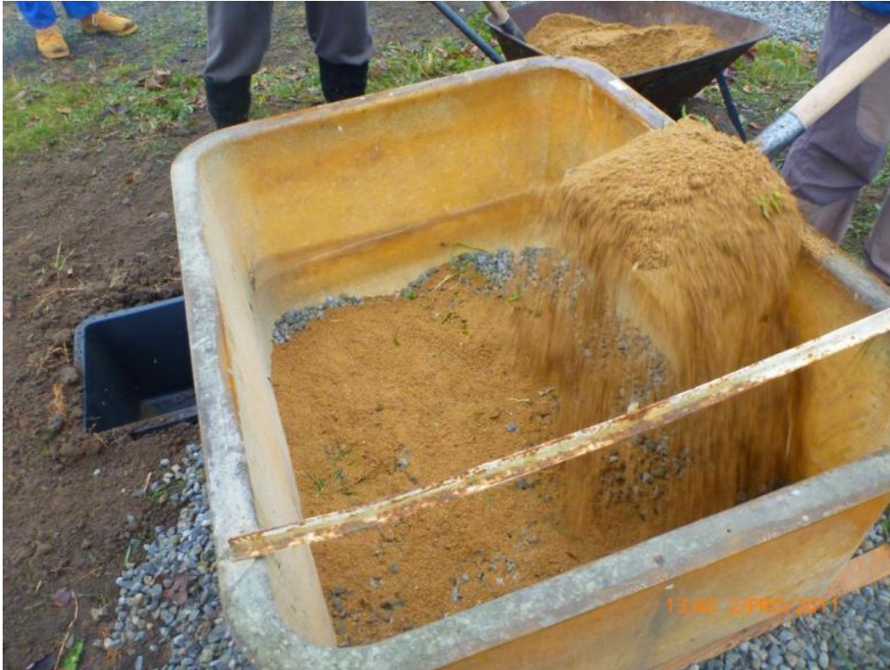
Obr. 14-11 Příprava odvodnění kalu v laminátovém lyzimetru
