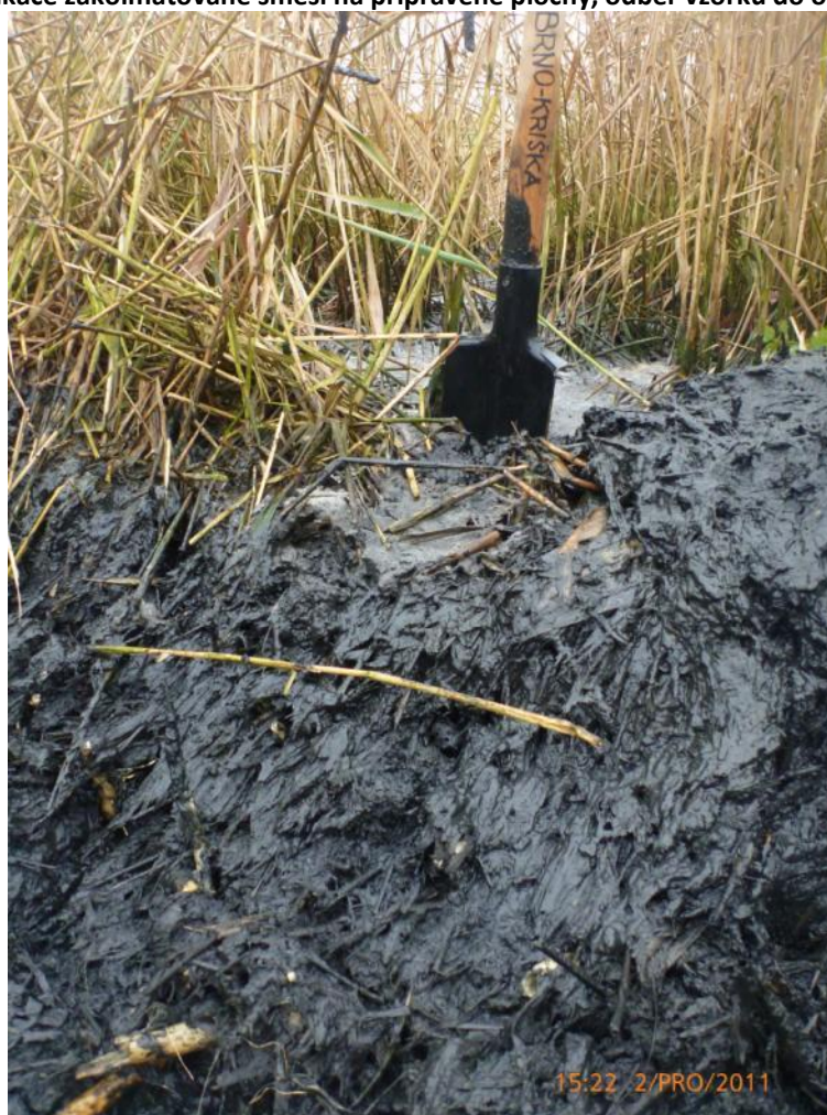
Obr. 14-21 Ukázka měření hloubky během těžení materiálu pomocí ostrého úzkého rýče
