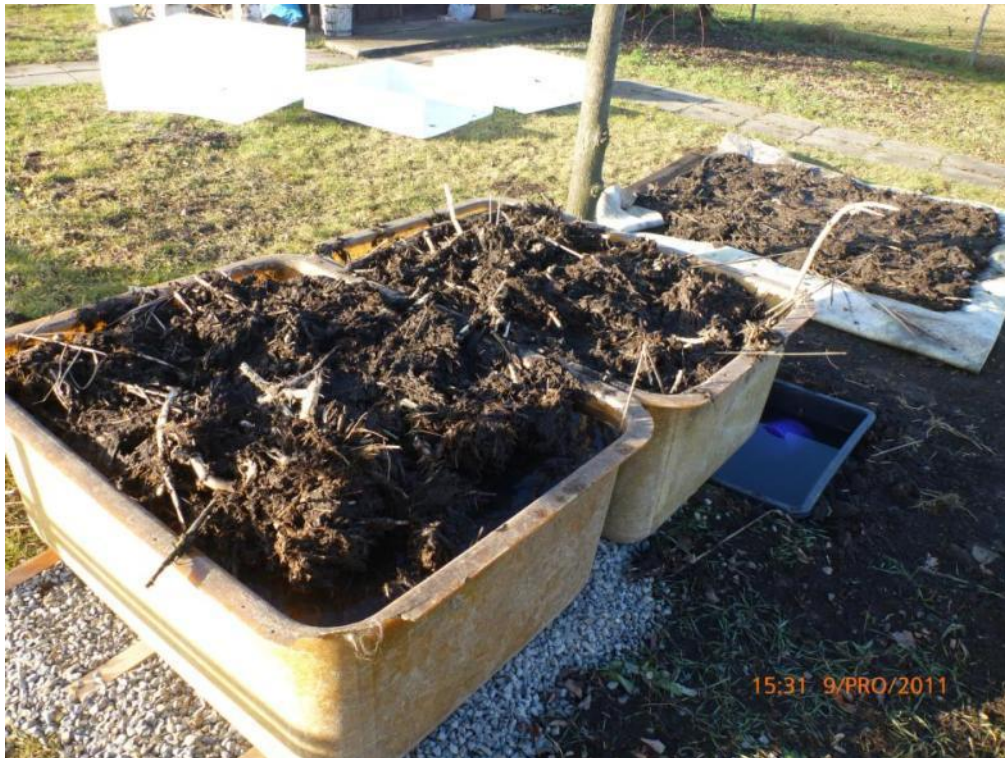
Obr. 14-14 Pohled na aplikovaný kal do lyzimetrů po týdenní aplikaci
