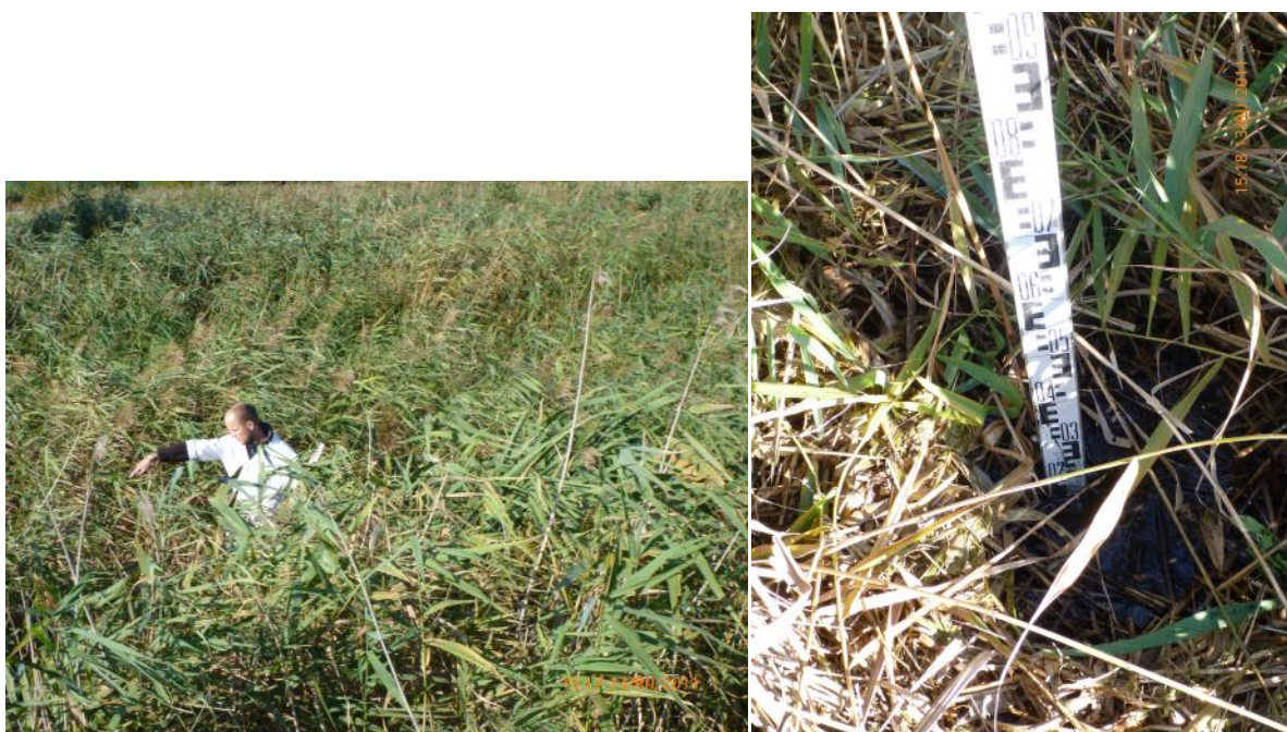
Obr. 5-1 Měření výšky vyplaveného kalu na filtračním poli
