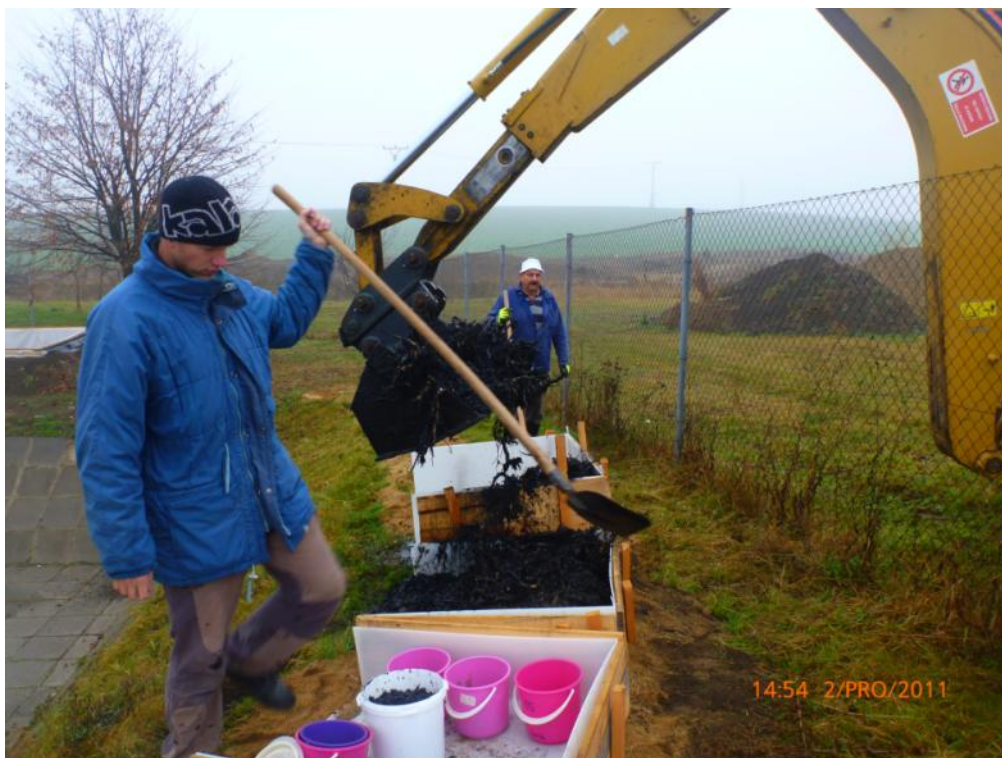
Obr. 14-20 Aplikace zakolmatované směsi na připravené plochy, odběr vzorků do odběrných nádob
