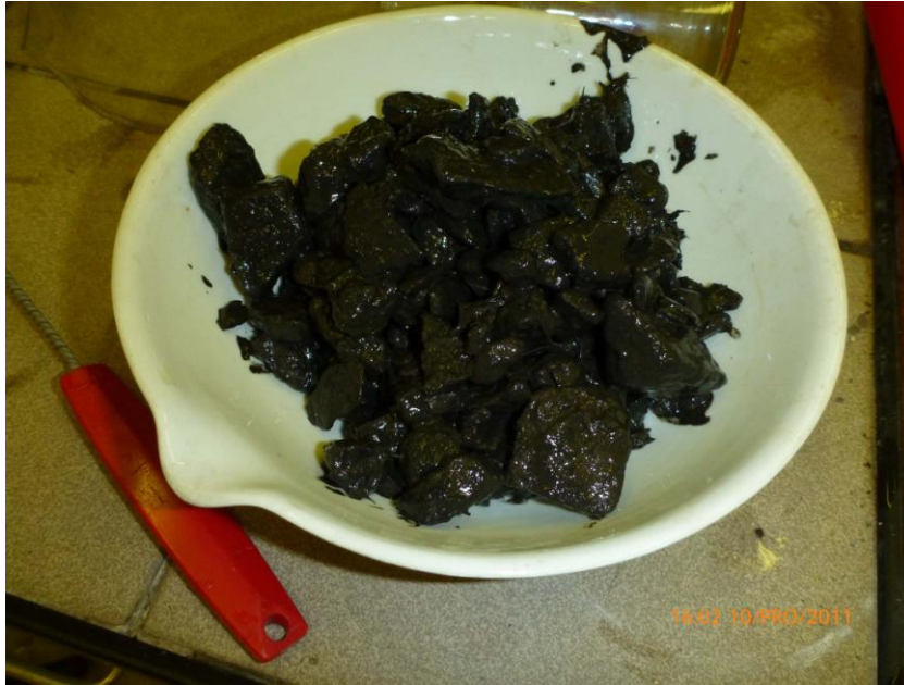
Obr. 4-1 Zakolmatovaný filtrační materiál, určený k laboratorním rozborům
