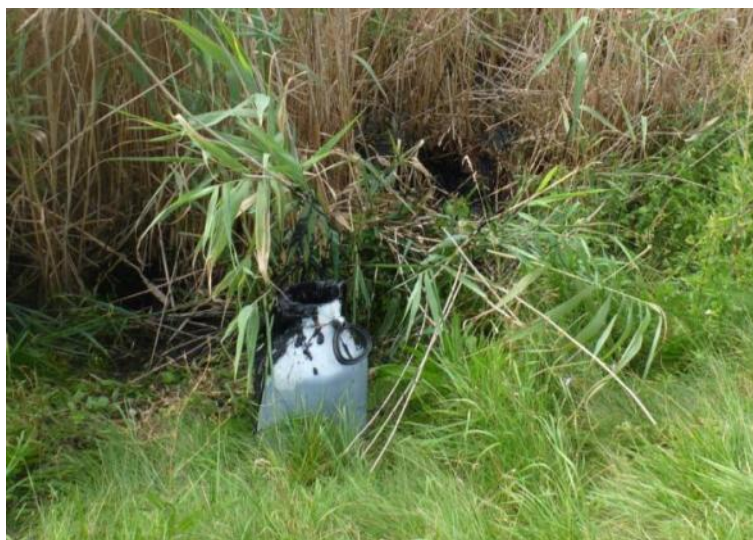
Obr. 4-2 Odběrná nádoba 25L, naplněná vyplaveným sedimentovaným primárním kalem
