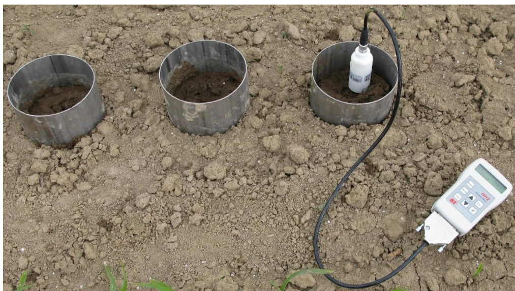
Obr. 2 Ukázka měření infiltrace vody
