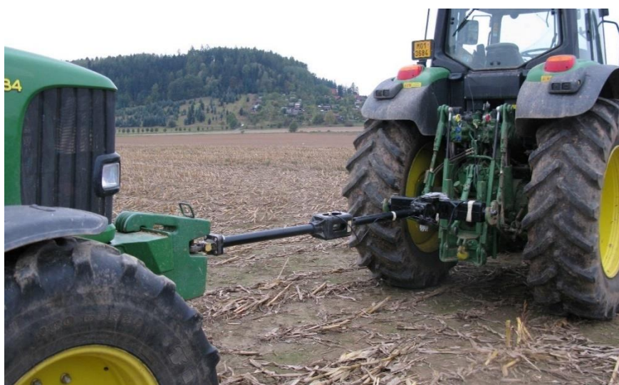
Obr. 4 Souprava pro měření tahového odporu 14.10.2016
